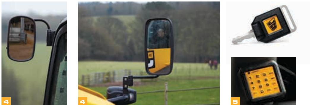
4 На телескопические погрузчики JCB Loadall можно установить полный комплект зеркал — боковых и заднего вида — для обеспечения круговой обзорности и соответствия требованиям безопасности.
