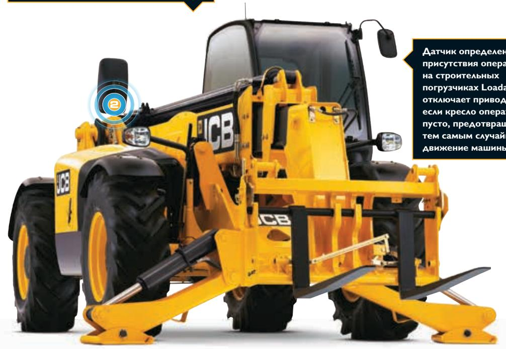
3 В строительных погрузчиках JCB Loadall обеспечена великолепная обзорность назад и по сторонам благодаря низко расположенной стреле, профилю капота и низко расположенному шарниру стрелы.
